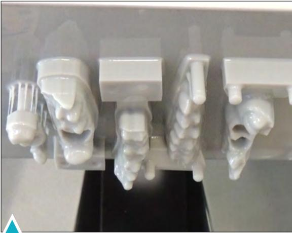
Abb. 14 Fertige Druckobjekte..
