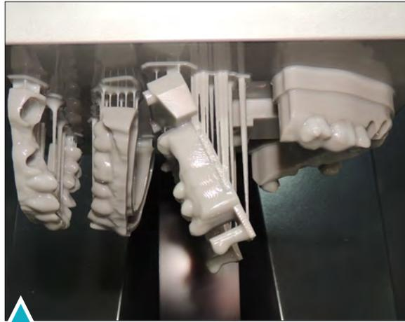
Abb. 15 Lösen der Druckobjekte.
