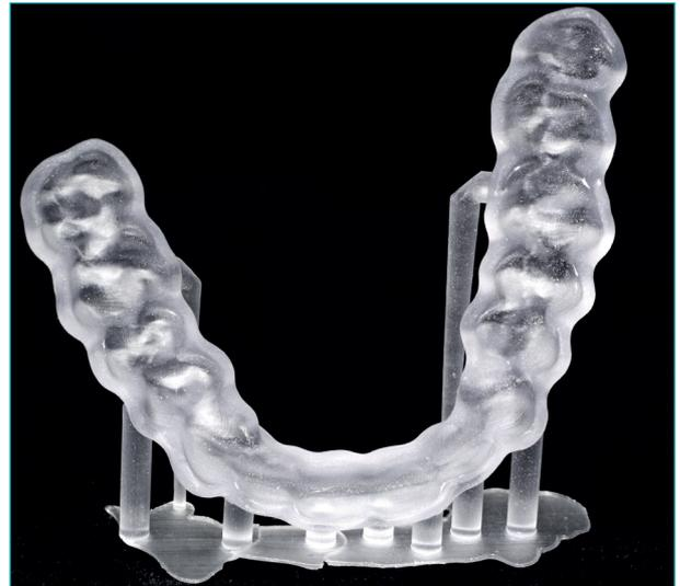
Abb. 3 Gereinigte Schiene auf Trägerplatte
